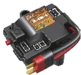
Gebürsteter ESC-Regler (Modell 18-01~18-64)
